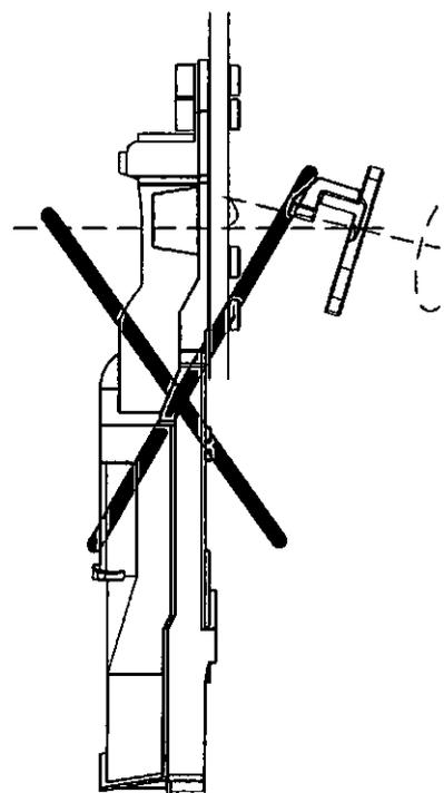
5 Il foro del dispositivo di chiusura e il morsetto di serraggio devono trovarsi in posizione parallela l'uno rispetto all'altro! Il morsetto di serraggio non deve venire montato in posizione inversa
