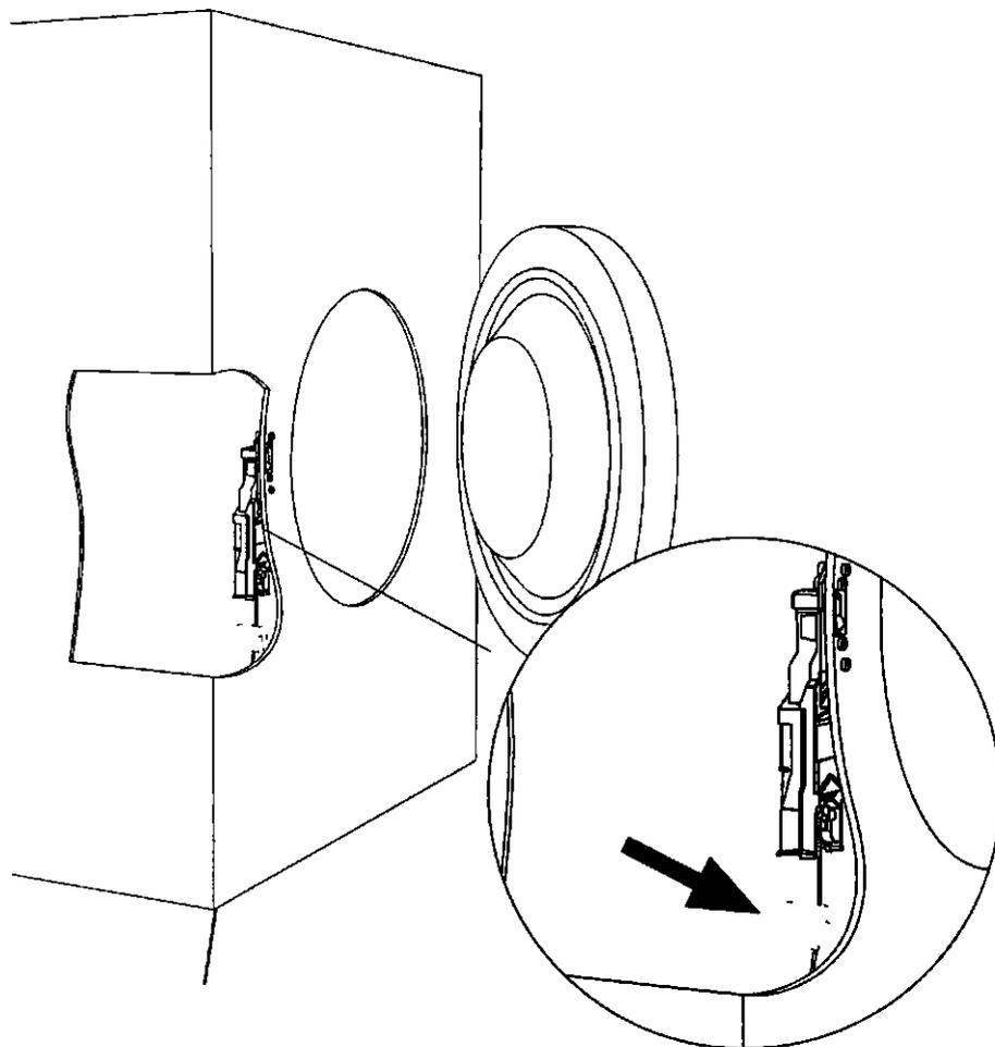
**2** Installate il galoppino per l'apertura di emergenza (in base alle esigenze del cliente) Provate il funzionamento e il percorso dell'apertura di emergenza!
