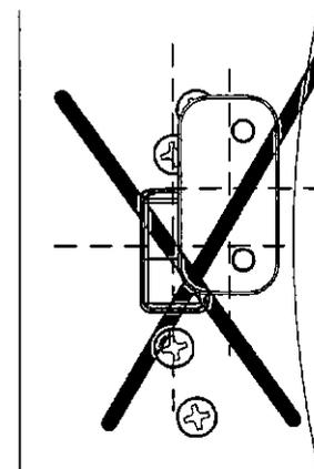
4 Il foro del dispositivo di chiusura e il morsetto di serraggio devono trovarsi in posizione centrale l'uno rispetto all'altro! (croce di collimazione unitaria)
