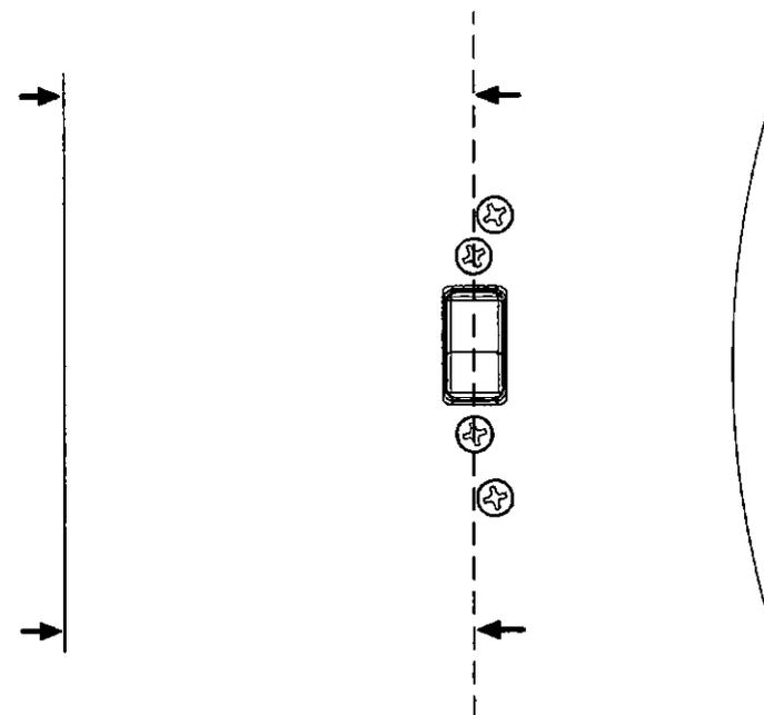
**3** La serratura elettromagnetica deve trovarsi in posizione parallela al telaio della porta
