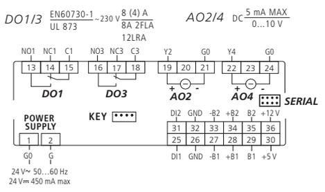
2.5 Raccordement des sondes IR33/DN33 Universale entrées universelles
