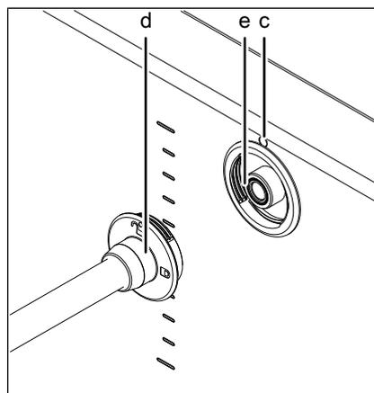
Bild: Reinigungslanze einsetzen
