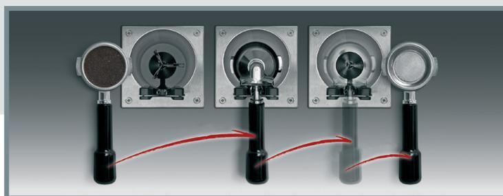
Inserendo il portafiltro nell'incastro del Pro - Fondi inizia a ruotare una spazzolina accoppiata ad un motore elettrico da 12 VDC. Il portafiltro viene perfettamente pulito senza rumore e stress dell'operatore. Il fondo del caffè cade direttamente nel
