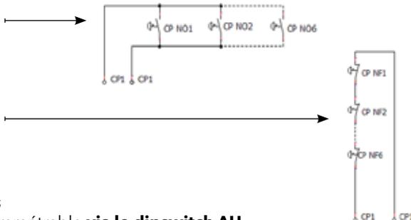
Si vous raccordez des contacts NF (Normalement Fermé), il faut les raccorder en série (voir ci-contre).
