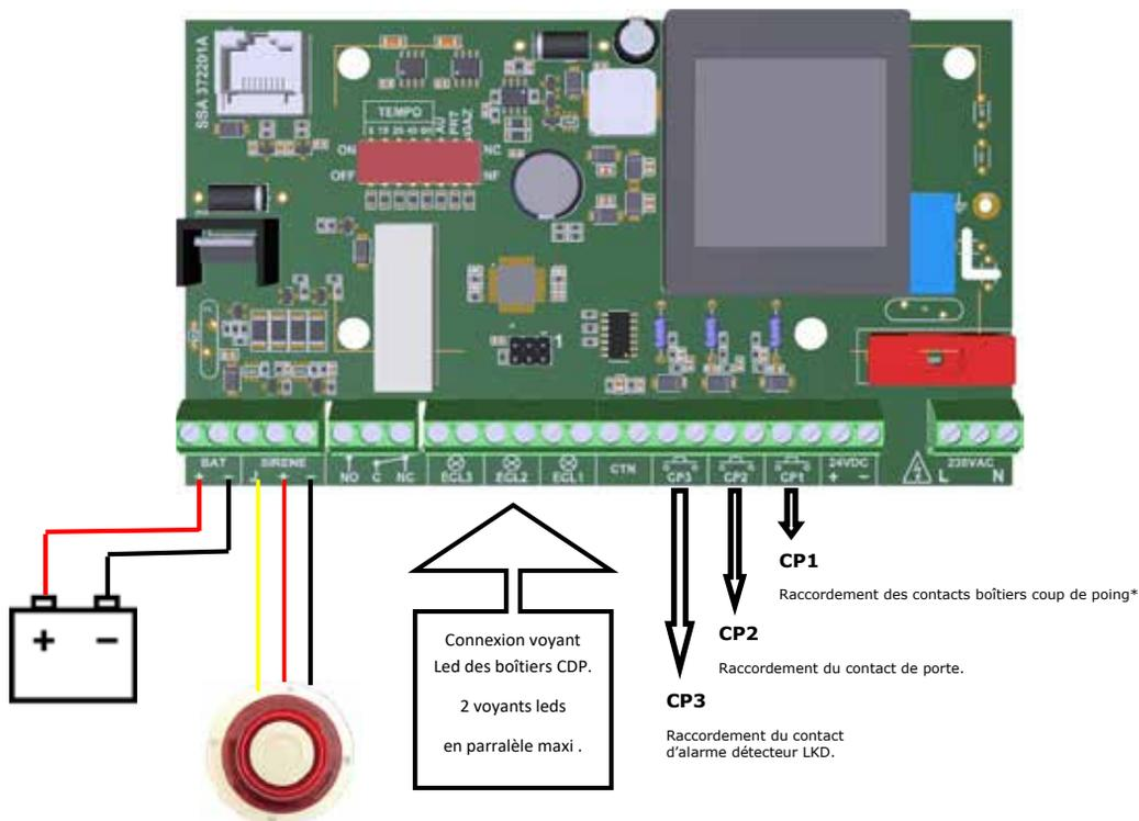
**Attention ! L'intervention sur les branchements électriques doit s'effectuer que si et seulement si l'appareil est HORS TENSION.**
