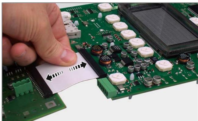
Bild: Flachbandkabel einstecken
