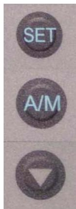
SET permet de basculer d'un paramètre à l'autre. Une pression continue de 5 secondes permet d'entrer en configuration 1 (paramètres PID+verrouillage de l'appareil).
