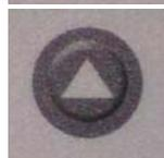
Touche permettant d'augmenter les valeurs du point de consigne, de la sortie ou d'un paramètre de configuration.
