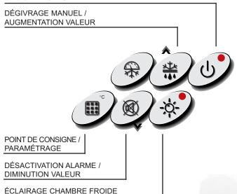
Le bouton ÉCLAIRAGE CHAMBRE FROIDE est doté d'une LED de signalisation d'état. La LED du bouton ON/OFF clignote pour indiquer l'état de stand-by.
