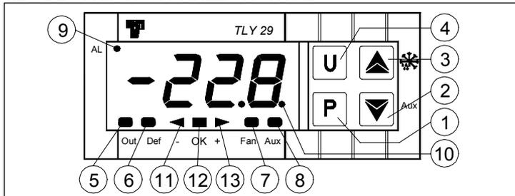
**1 - Tecla P:** Permite configurar el Set Point y programar los parámetros de funcionamiento.
