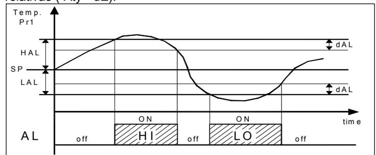
Las alarmas de temperatura de máxima y mínima se pueden desactivar programando los parámetros "HAL" y "LAL" = OFF.
