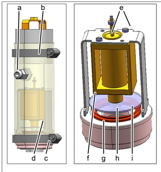
a Dichtung Kabeldurchführung                      b Obere Schelle
