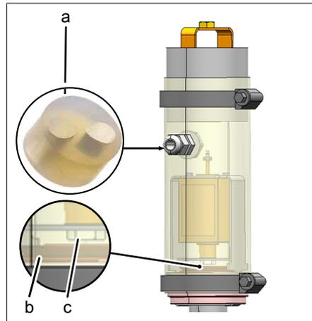
a Einsatz Kabeldurchführung                      b Dichtung
