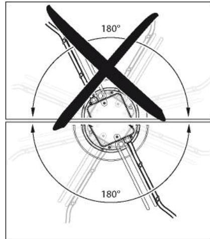
Fig. 3: Posa dei cavi nei ventilatori verticali.
