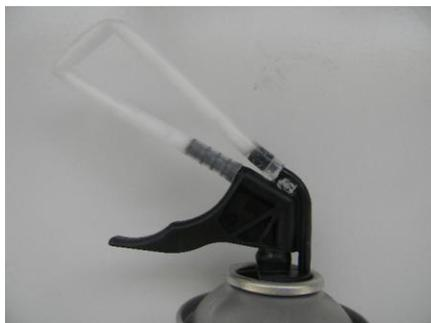
Pour nettoyer complètement l'aérosol, démonter le bec extrudeur et nettoyer soigneusement toutes les parties (valve, bec et canule) avec le NETTOYANT POUR MOUSSE POLYURETHANE.
